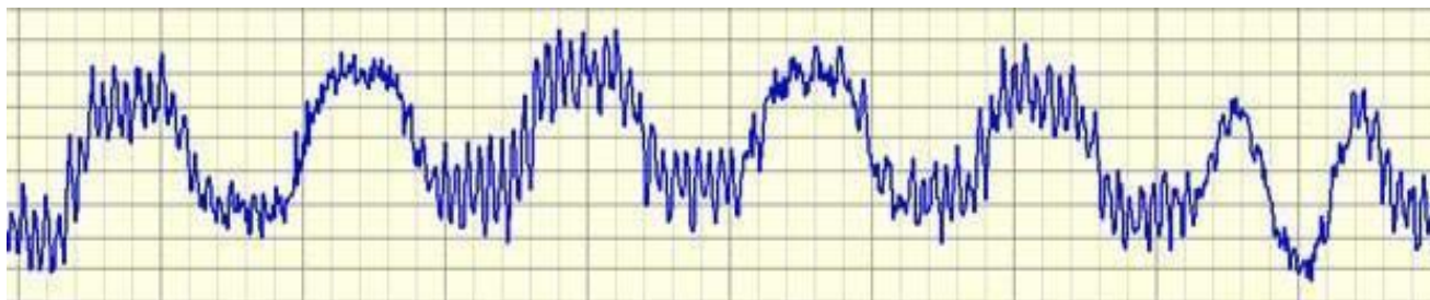
Рис. 19 Пример синхроимпульса на сыром сигнале
